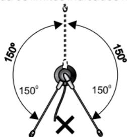
O ajuste da posição do Fone de Cabeça (direita ou esquerda) deve ser efetuado girando o **Suporte de Microfone** a um limite de 300°, sempre passando pela **Tiara**.
