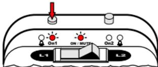
Após a retenção da Linha 1, pressione a **chave ON/OFF** para ligar a Linha 2.
