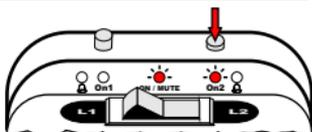
Após a retenção da Linha 2, pressione a **chave ON/OFF** para ligar a Linha 1.
